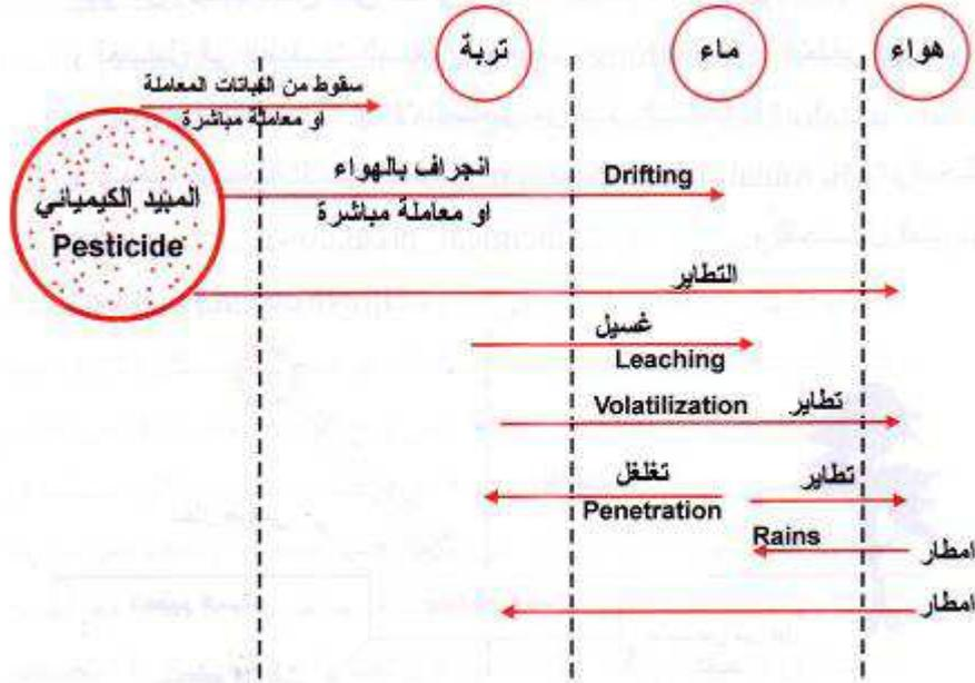
شكل (11) مخطط يوضح تسرب المبيدات الكيميائية الى التربة و الماء والهواء والحركة بينها.
